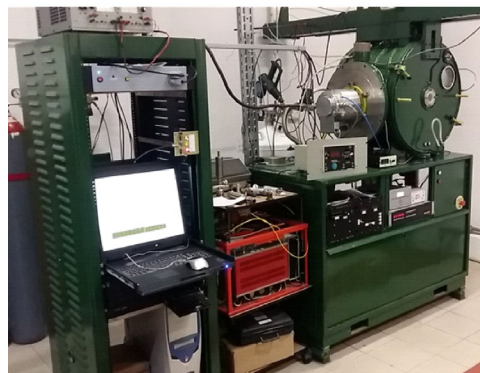
Instalatie teste vid cicluri termice
